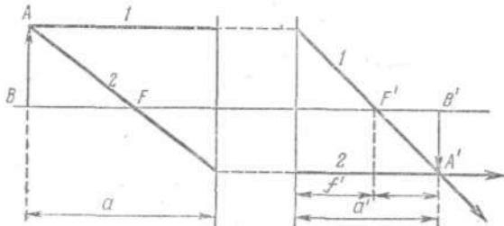
Рис. 7. Построение оптического изображения предмета двумя лучами, проходящими через двояковыпуклую линзу
