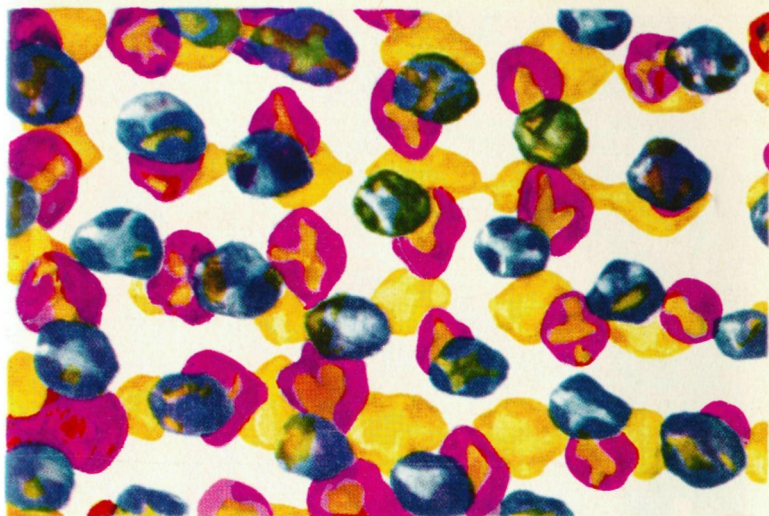
Фото 9. Часть фотографии, полученной методом высокой печати, при большом увеличении.
